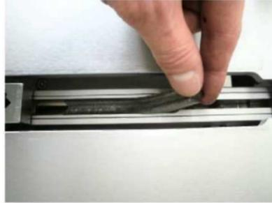
Вставьте пневматическую подающую трубку непосредственно в станок (либо в фильтр, если он имеется).
