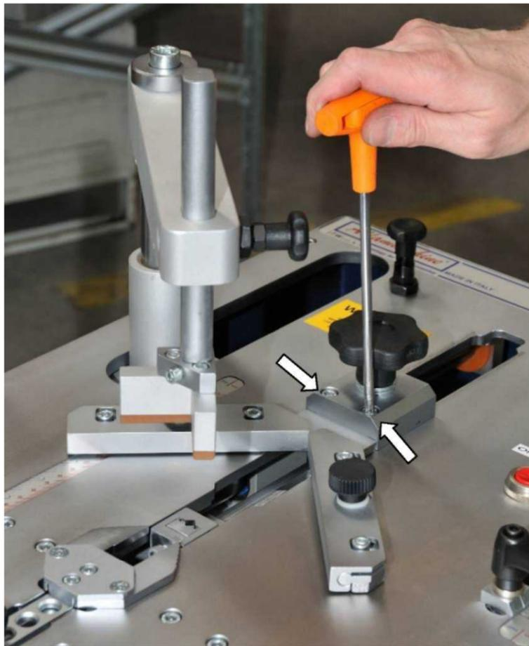
Выньте все болты, затем выньте и удалите опоры фиксированных ограничительных рамок. Для монтажа новых ограничительных рамок следуйте этой процедуре в обратном порядке и повторно затяните 2 болта с внутренним шестигранником.
