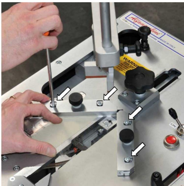
Для демонтажа передвижного узла ограничительной рамки лишь ослабьте головку.
