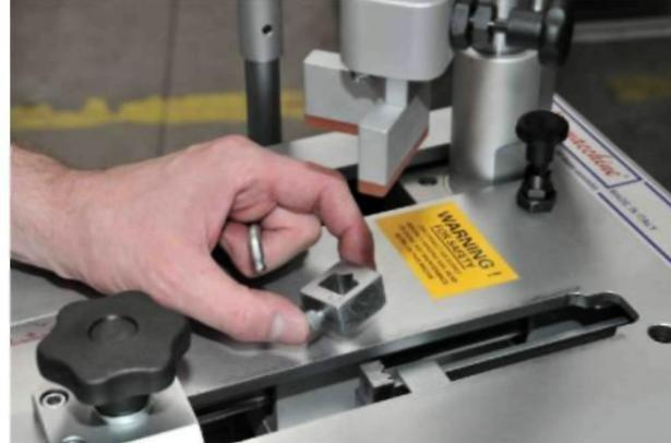
Удалите переднюю часть захватного устройства.
