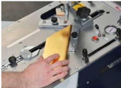
Нажмите на педаль для горизонтальной блокировки с помощью откидного стержня.
