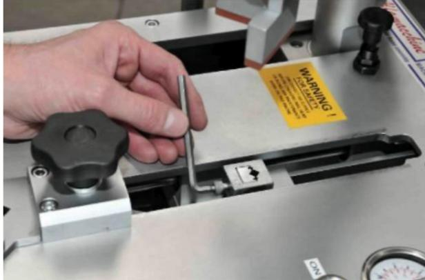
Ослабьте 5мм винт с внутренним шестигранником, который фиксирует переднюю часть захватного устройства.
