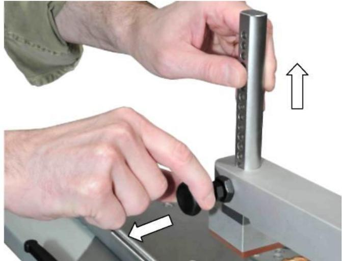
Если необходимо, подгоните фиксирующую рукоятку передвижной ограничительной рамки, поднимите удерживаемую вертикальную пластину, вытащив головку штифта фиксатора
