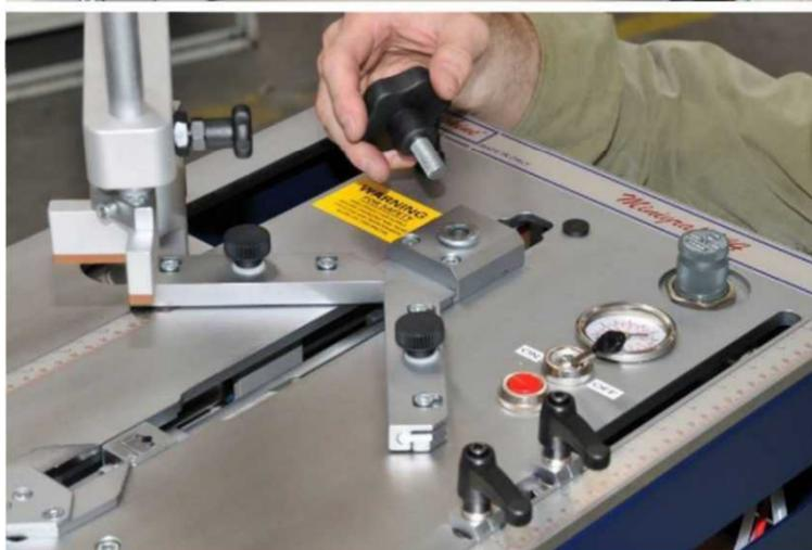
После ослабления головки, удалите направляющую в нижней части верстака.
