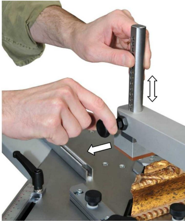
Для замены пластины необходимо ослабить болт, который фиксирует стержень, затем удалите его, вытащив снизу.
