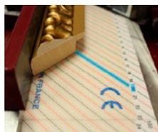
Разноцветная измерительная шкала с косой разметкой, позволяет быстро отмерить размер плеча.
