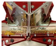
Защитные щитки из плексигласа для безопасной работы.
