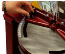
Фиксаторы угла 45°, всегда точный угол реза. Дополнительные метки для 5, 6, 8 угловых рам.
